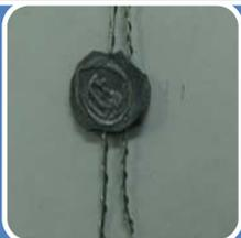
**In caso di riparazione** dello strumento metrico che comporti la rimozione dei sigilli metrici: in questo caso il riparatore ha dovuto rimuovere i sigilli per la riparazione dello strumento. Egli appone i propri sigilli provvisori che verranno rilegalizzati attraverso la verifica periodica.
